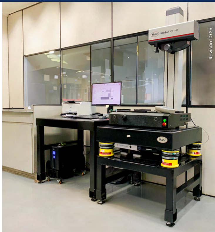
Estação de medição em bancada Vibtech
