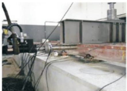
Figura 6 - Ensaio estático – atuadores e transdutores de deslocamento
