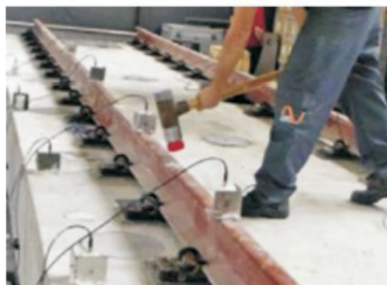
Figura 10 - Ensaio dinâmico com carga impulsiva (martelo instrumentado)
