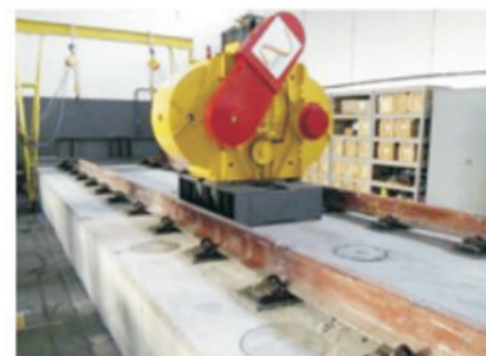
Figura 13 - Vibrodina para realização do ensaio de fadiga nos protótipos
