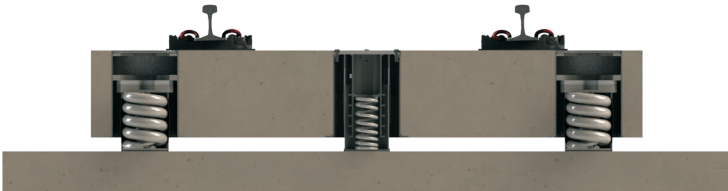
Figura 07. Sistema massa-mola de frequência natural de 4,9 Hz. Sistema amortecido através de amortecedores hidráulicos centrais.
