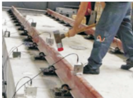
Figura 10 - Ensaio dinâmico com carga impulsiva (martelo instrumentado)
