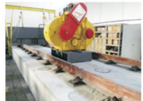
Figura 13 - Vibrodina para realização do ensaio de fadiga nos protótipos
