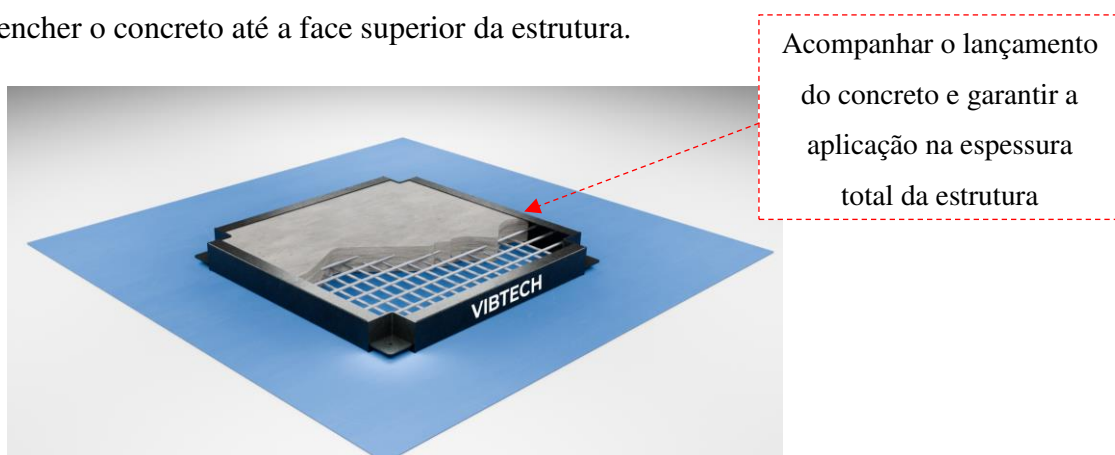
Figura 4: Representação da concretagem da estrutura.
